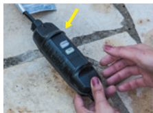
4. Drücken Sie die Reset-Taste, die Anzeige leuchtet auf. Der FI-Stecker ist einsatzbereit.
