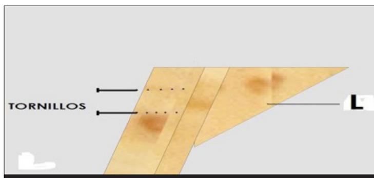
También hay que dejar unido a todos los paneles la pieza que sirve de apoyo para las playas, pieza **L**. Se atornillara desde fuera de cada panel usando tornillos de **4 x 50**, como se muestra a continuación usando los agujeros guía.
